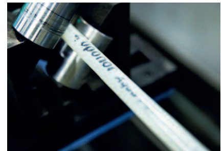
Herstellung von PEX-Rohren bei Uponor (Foto: © Uponor)
