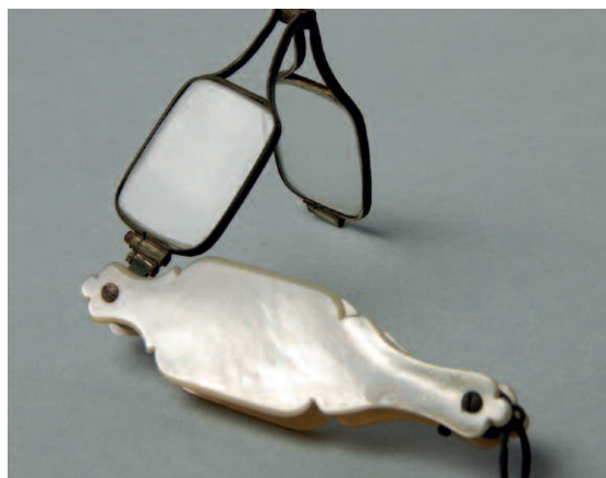
Lesehilfe aus dem beginnenden 20. Jahrhundert, Lorgnon genannt, aus Cellulosenitrat. Ganz links: Detailaufnahme der Lesehilfe mit austretendem Weichmacher auf der Oberfläche
