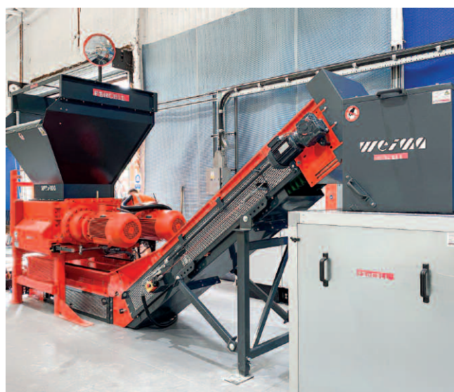
Zweistufige Zerkleinerung mit Shredder und Schneidmühle von WEIMA
